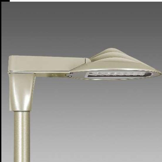
Corpo e telaio: in alluminio pressofuso e disegnati con una sezione a bassissima superficie di esposizione al vento. Alette di raffreddamento integrate nella copertura. Attacco palo: in alluminio pressofuso. Idoneo per pali di diametro da 60 mm.
