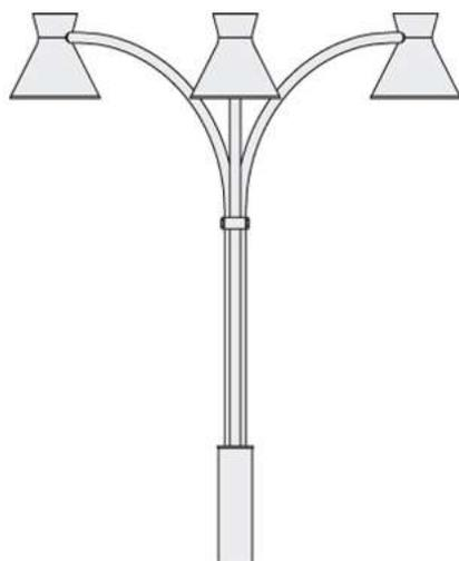
Pali in acciaio Ø 193 verniciato color argento. Completi di finestra di ispezione (239x93mm) di morsettiera asportabile a 4 poli e 16mm2 sezione max. Completo di 2 portafusibili di protezione e di 2 fusibili da 16A. Predisposto con foro per ingresso cavo di alimentazione. Per la versione con base è necessario acquistare 4 tirafondi da interrare, bulloneria e tappi.
