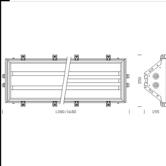
**CORPO:** In alluminio estruso anodizzato, con testate in pressofusione, ed ampie alettature di raffreddamento.
