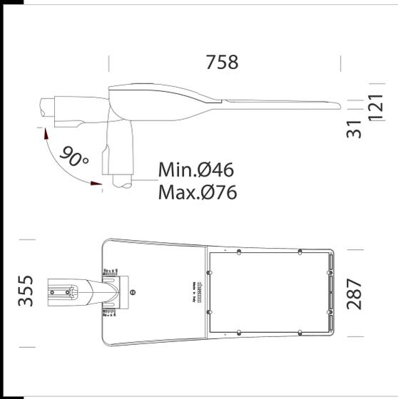
Giovi rappresenta l'ultima generazione di apparecchi per l'illuminazione stradale a LED, progettati per le nuove sorgenti luminose e per i più recenti sistemi di gestione e controllo della luce. Il suo corpo in alluminio pressofuso, il cui basso profilo riduce al minimo la resistenza al vento, è dotato di alette di raffreddamento appositamente studiate per una dissipazione del calore che permette il funzionamento ottimale dei LED.
