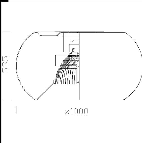
"Venere" è una lampada a sospensione o a soffitto di grandi dimensioni realizzata in materiale plastico, nata per utilizzare le nuove tecnologie, lampade fluorescenti compatte, lampade a scarica o LED, è proposta in materiale semi-trasparente per le versioni con illuminazione interna.
