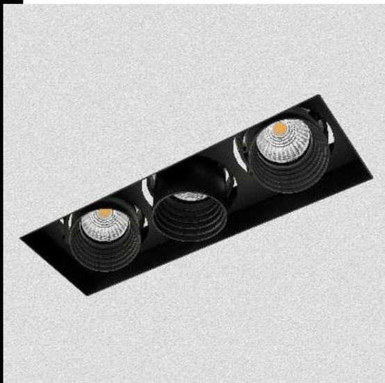
Corpo: in alluminio pressofuso con farette orientabili e basculanti. Equipaggiamento: completi di staffe di sostegno in acciaio zincato che assicurano una perfetta aderenza al controsoffitto di spessore da 12 mm a 25 mm. Riflettore: in policarbonato metallizzato ad alto rendimento. Normativa: Prodotti in conformità alle norme EN 60598-1-CEI 34.21, hanno grado di protezione secondo le norme EN 60529.
