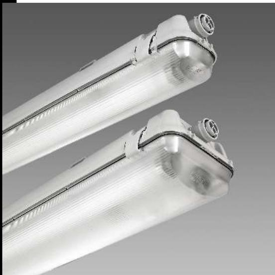
**CORPO:** Stampato ad iniezione, in policarbonato grigio RAL7035, infrangibile ed autoestinguente V2, di elevata resistenza meccanica grazie alla struttura rinforzata da nervature interne.
