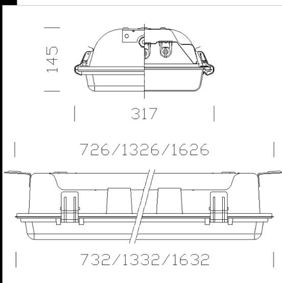
**CORPO:** In acciaio inox AISI 304 18/8 imbutito in un unico pezzo di elevata resistenza meccanica.
