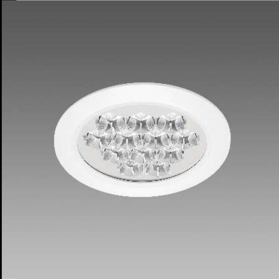
Corpo: in alluminio pressofuso. Lenti: in PMMA ad alta efficienza con bassissimo coefficiente di abbagliamento. Schermo dark light: in materiale plastico metallizzato antiabbagliamento. Verniciatura: a polvere con vernice epossidica in poliestere resistente ai raggi UV. Equipaggiamento: i faretto sono dotati di staffe di sostegno in acciaio zincato, con alloggiamento per molle di fissaggio al controsoffitto.
