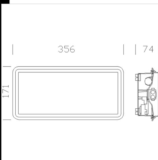
**CORPO:** Stampato ad iniezione, in policarbonato grigio RAL7035, infrangibile ed autoestinguente V2, stabilizzato ai raggi UV, di elevata resistenza meccanica grazie alla struttura rinforzata da nervature interne.
