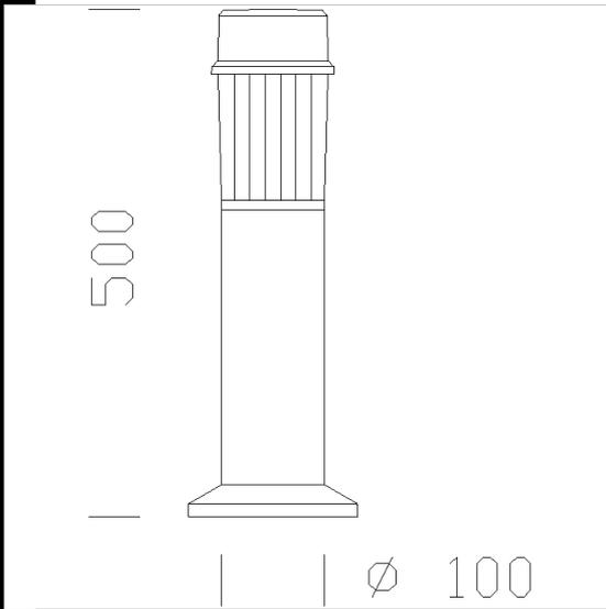
**CORPS:** en aluminium extrudé, de section cylindrique Ø 100, avec calotte moulée sous pression.
