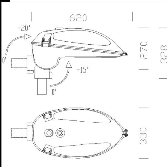
**CORPS/CADRE:** En aluminium moulé sous pression.
