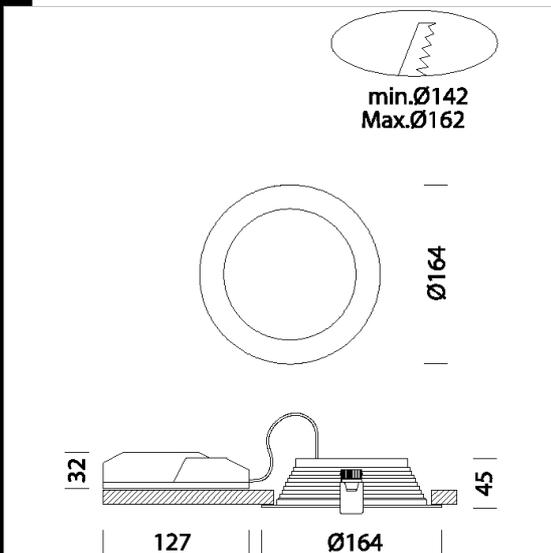
La nouvelle série de downlights Eco Lex LED permet d'obtenir la technologie et l'économie d'énergie des LED avec un produit facile à installer, économique, résistant et durable. Les trois diamètres (164, 192, 220 mm) multiplient les possibilités d'encastrement.
