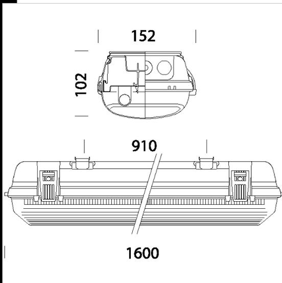
**CORPS:** moulé par injection, en polycarbonate gris RAL 7035, incassable et auto-extinguible V2, à résistance mécanique élevée grâce à sa structure renforcée avec des nervures internes.
