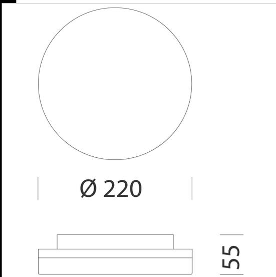
Oblò 2.0 rappresenta l'evoluzione d'un prodotto storico di Disano, raffaïchi au niveau du design et de la technologie, pour faire dégringoler la consommation énergétique tout en maximisant la qualité de la lumière LED. Oblò 2.0 est une famille complète de luminaires robustes et fiables, à poser sur mur en extérieur ou en intérieur, avec un corps en polycarbonate autoextinguible, degré de protection IP 65 et isolation en classe II.
