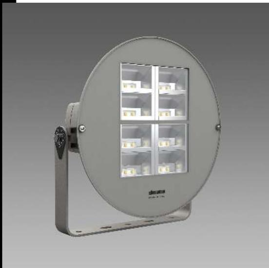
Cuerpo: de aluminio inyectado fundido a presión, con aletas de enfriamiento. Óptica: de aluminio recubierto de plata de altísima pureza 99,99% con procedimiento al vacío (PVD). Difusor: cristal templado de 5 mm de espesor resistente a los choques térmicos y a los golpes.
