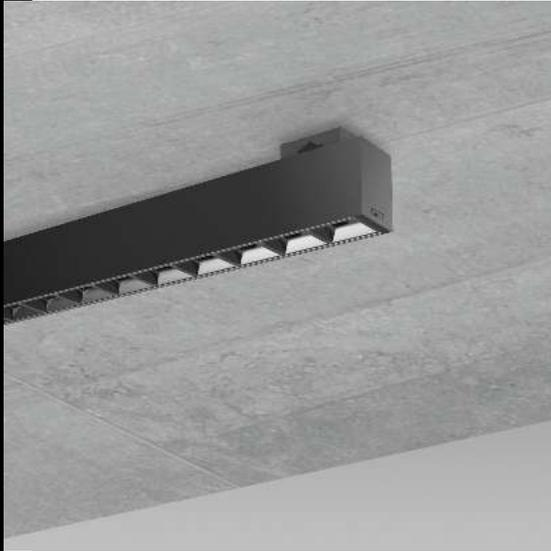
Cuerpo: de aluminio extrudido. Cabezales: de aluminio fundido a presión. LED: Mantenimiento del flujo luminoso al 80%: 50.000h (L80B20). Factor de potencia 0,92. Clasificación riesgo fotobiológico: Grupo exento Normativa: fabricado conforme a las normativas vigentes EN60598-1 CEI 34-21, grado de protección según la normativa EN 60529.
